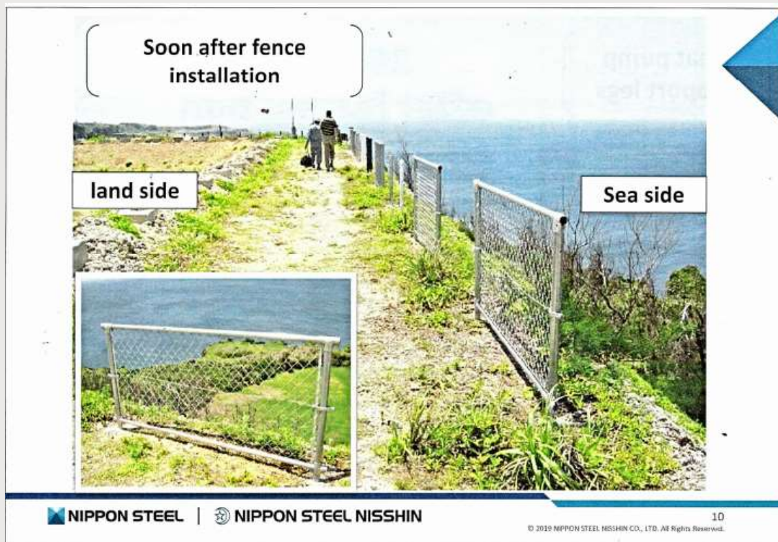
Khung hàng rào tôn ZAM được dựng tại vùng ven biển có khí hậu khắc nghiệt để kiểm tra theo dõi trong hàng chục năm
